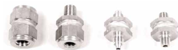
Serie 82 Filtros TIPO MINI IN- LINE Construção Hexagonal acima de 6.000 psi / 1/8"à 3/4" macho ou fêmea NPT
