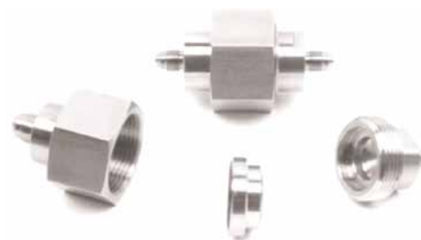
Serie 88 Filtros MINI IN- LINE Aço inoxidável acima de 6.000 psi / 1/8"à 1/2" macho ou fêmea NPT
